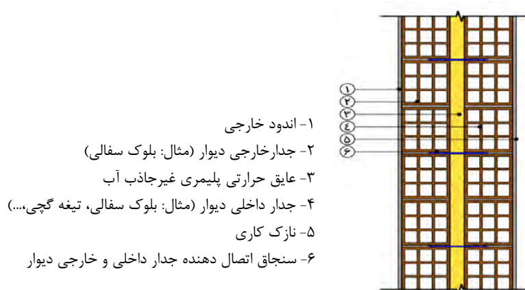
شکل ۱۰-۲۱- عایق‌کاری حرارتی دیوار به صورت میانی
